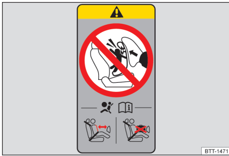
Рис. 2 Наклейка подушки безпеки на стійці А або на стійці В (зображення принципу дії).
